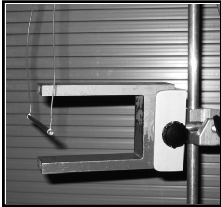
Abbildung 5a: Versuchsaufbau mit Hufeisenmagnet, der Kupferstab befindet sich in der Ruhelage
