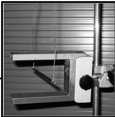
Abbildung 3a: Versuchsaufbau mit Hufeisenmagnet, der Kupferstab befindet sich in der Ruhelage
